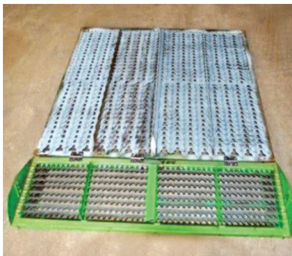
Рисунок 3 – Верхнее решето с изменённой конструкцией лепестков жалюзи и штатный удлинитель
